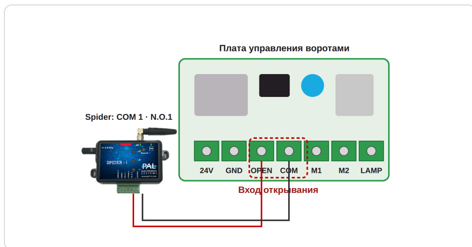
Рис. 4 – Подключение Spider ко входу открывания платы управления (общая схема)
